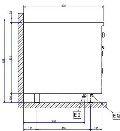
EI = Conexión eléctrica (energía)
